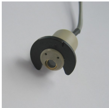
Abbildung 2: UV-Photodiode in Kunststoff-Fassung mit Befestigungs-Clip. An der Kunststoff-Fassung ist außerdem ein Temperatursensor angebracht (in diesem Photo nicht montiert)
