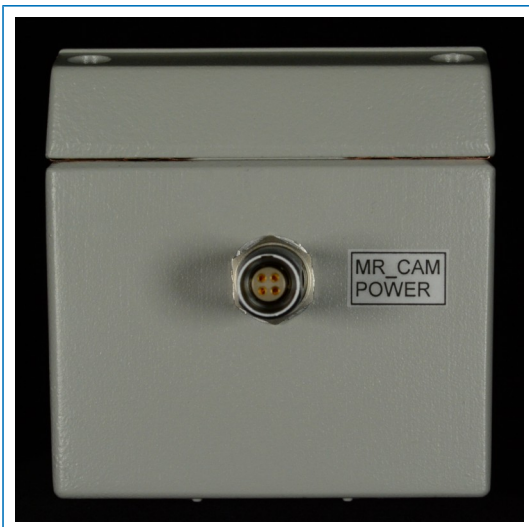
Abbildung 4: Filterbox (Vorderseite) mit Spannungsanschluss
