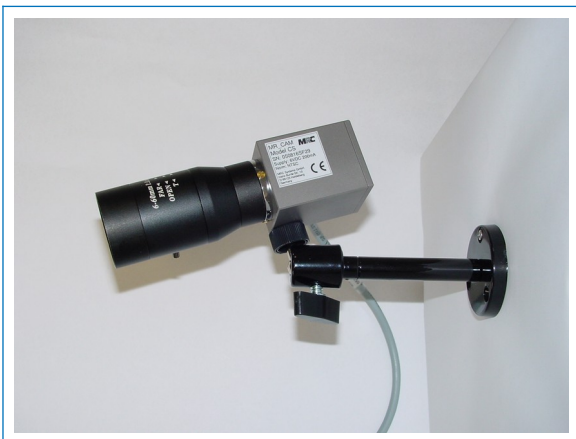
Abbildung 5: Kameramontage mit Wandhalter
