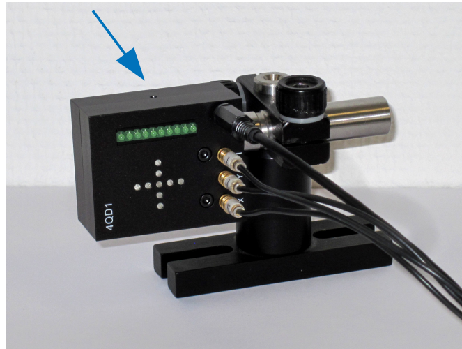
Abbildung 4: 4-Quadrantendiode. Der Pfeil zeigt auf das Potentiometer zur Intensitätsaussteuerung (mit Schraubenzieher zugänglich).
