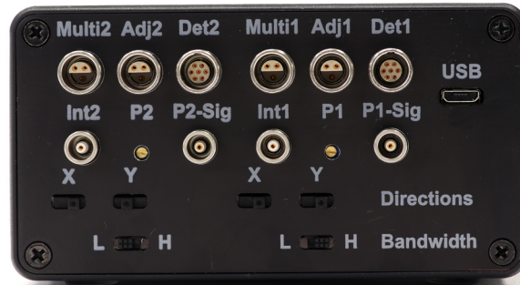
Abbildung 25: Rechte Seitenplatte mit zusätzlichen „Adjust-in“-Eingängen zur Verstellung der x und y Sollposition auf zwei PSDs
