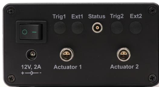
Abbildung 6: Spannungseingang und Ausgangsbuchsen an der linken Gehäuseseite
