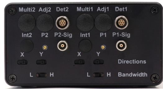
Abbildung 7: Eingangsbuchsen, P-Faktor-Einstellungen und Schalter an der rechten Gehäuseseite
