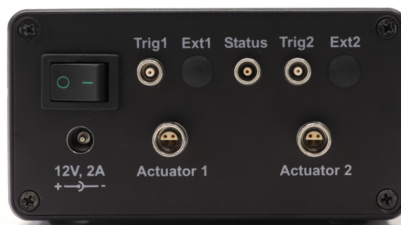
Abbildung 17: Linke Seite der Steuerungselektronik mit Trigger-Eingängen
