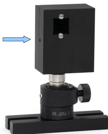
Abbildung 14: 4-Quadranten-Diode. Der Pfeil zeigt auf das Potentiometer zur Intensitätsaussteuerung (mit Schraubenzieher zugänglich).
