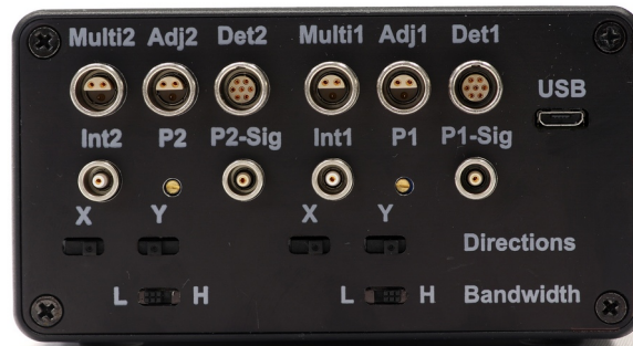
Abbildung 4: Seitenplatte des Compact-Controllers mit zusätzlichen „Adjust-In“-Eingängen zur elektronischen Verstellung der x- und y-Sollpositionen auf den PSD-Detektoren.
