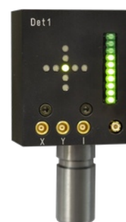
Abbildung 2: Detektor mit Positions- und Intensitäts-Anzeigen sowie Anschlüssen
